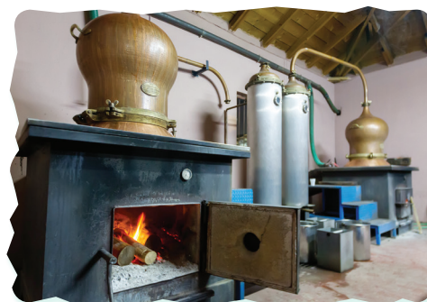
Obținerea băuturilor alcoolice în instalații industriale (alambic)
