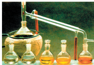
Fig. 2.15. Instalație de distilare (obținerea etanolului)
