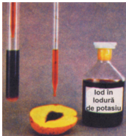
Fig. 5.5. Identificarea amidonului cu iod
