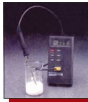
Fig. 8. Reacția endotermă dintre \text{NH}_4\text{SCN} și \text{Ba}(\text{OH})_2 ; temperatura scade de la 20^\circ\text{C} la -9^\circ\text{C} .
