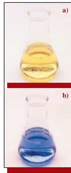
Fig. 75. Indicatorul bromtimol: a) în mediu acid (galben); b) în mediu bazic (albastru).
