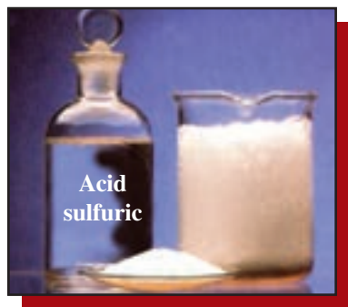
Fig. 60. Reacția \text{Na}_2\text{CO}_3 solid cu \text{H}_2\text{SO}_4 . Eferescența se produce deoarece \text{H}_2\text{SO}_4 deplasează \text{H}_2\text{CO}_3 din sarea sa, acesta descompunându-se în \text{CO}_2 și \text{H}_2\text{O} .
