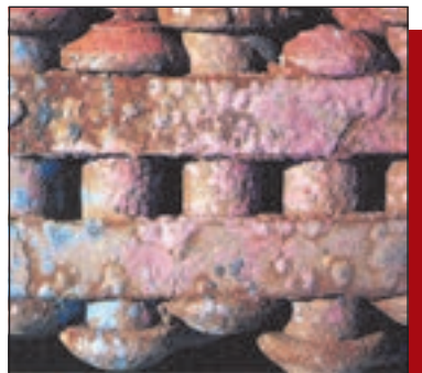
Fig. 2. Ruginirea fierului este un proces redox. Cunoașterea reacțiilor care se produc este importantă pentru identificarea metodelor de combatere a coroziunii fierului.
