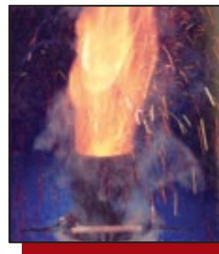
Fig. 9. Reacția exotermă dintre \text{Al} și \text{Fe}_2\text{O}_3 , cunoscută sub denumirea de „reacție termită”, decurge violent după momentul declanșării.
