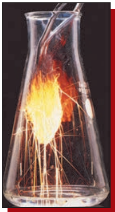
Fig. 27. Când pilitura de fier este încălzită în aer nu arde. Când se încălzeşte în atmosferă de oxigen, reacţia este energetică, aşa cum apare în imagine. Diferenţa de comportament se datorează diferenţei concentraţiei oxigenului în cele două medii. Concentraţia reactanţilor influenţează viteza de reacţie.
