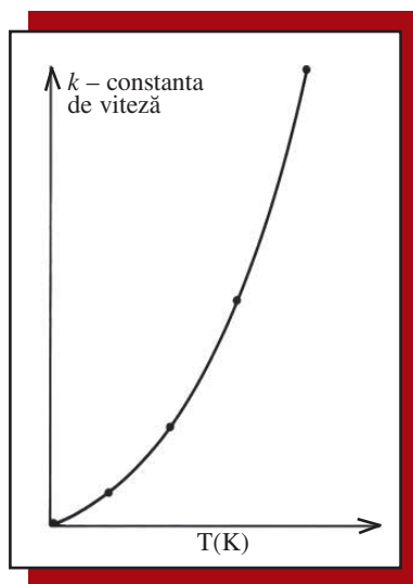
Fig. 29. Diagrama reprezintă creșterea exponențială a constantei de viteză k în funcție de temperatura absolută ( T ).
