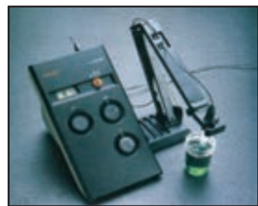
Fig. 73. pH-metru, aparat pentru măsurarea valorii pH-ului.
