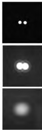
Fig. 4.43. Imaginea a două surse punctiforme. Sus: apertură largă, sursele se disting clar. Jos: apertură mică, sursele se confundă
