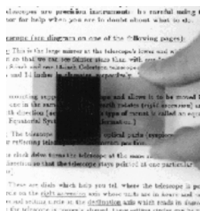
Fig. 4.52. Polarizorii încrucișați opresc trecerea luminii
