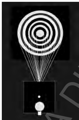
Fig. 4.33. Lumina produsă de bec suferă la trecerea prin orificiul circular fenomenul de difracție și produce pe ecran o imagine cu cercuri luminoase și întunecoase
