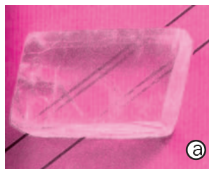
Fig. 5. Într-un cristal birefringent (a), un fascicul de lumină este împărțit în două: unul tangent la undele sferice (b), iar celălalt tangent la undele elipsoidale (c).
