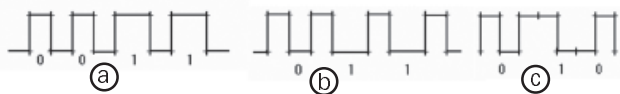
Fig. 6. Tipuri de pulsuri utilizate în transmiterea mesajelor în cod binar: semnale codate prin lungimea pulsului (a); semnale codate prin lungimea spațiilor dintre pulsuri (b); variația ordinii pulsurilor (c).
