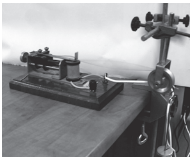
● Fig. 1.3.5.10 – Montaj experimental – coarda vibrantă
