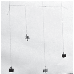
Fig. 1.2.1.3 – Montaj experimental – cuplaj slab de pendule gravitaționale
