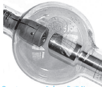
● Fig. 2.4.9 – Tub Roentgen – sursă de radiații X
