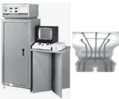
Aparat RÖNTGEN modern și imaginea conexiunilor interioare ale unui bec.
