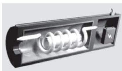
Fig. 3.29. LASER cu cristal de rubin.
