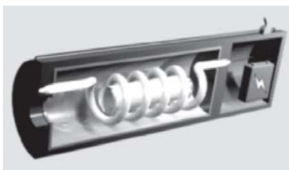
Fig. 3.29. LASER cu cristal de rubin.
