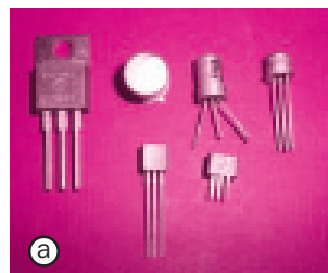
Fig. 1. Diferite tipuri de tranzistori (a). Configurația tranzistorilor p-n-p și n-p-n (b) și simbolurile de reprezentare ale acestora în scheme electronice (c).
