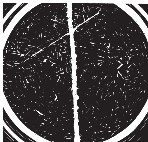
Fig. 5.15. Traiectoriile, într-o cameră cu ceață, a două nuclee rezultate din fisiunea nucleului ^{235}_{92}\text{U} .
