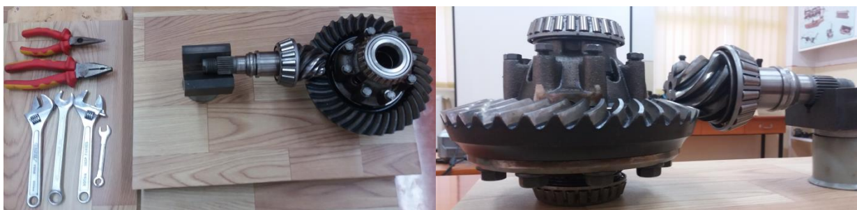
Fig. 5. Grup Transmisie principală – diferențial (automobil Dacia)
