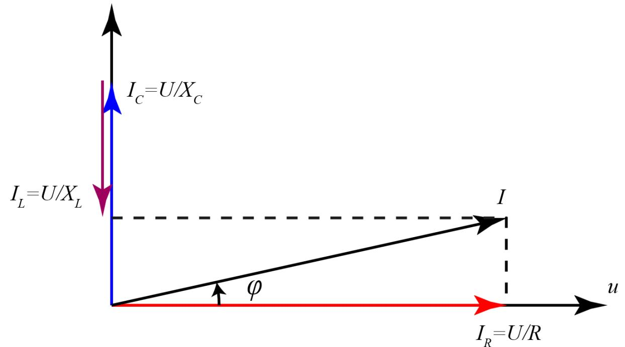
Suma vectorială a celor trei fazori reprezentând intensitatea curentului prin ramuri este egală cu intensitatea curentului total. Din diagramă se observă că intensitatea este înaintea tensiunii cu un unghi care poate fi calculat astfel:
