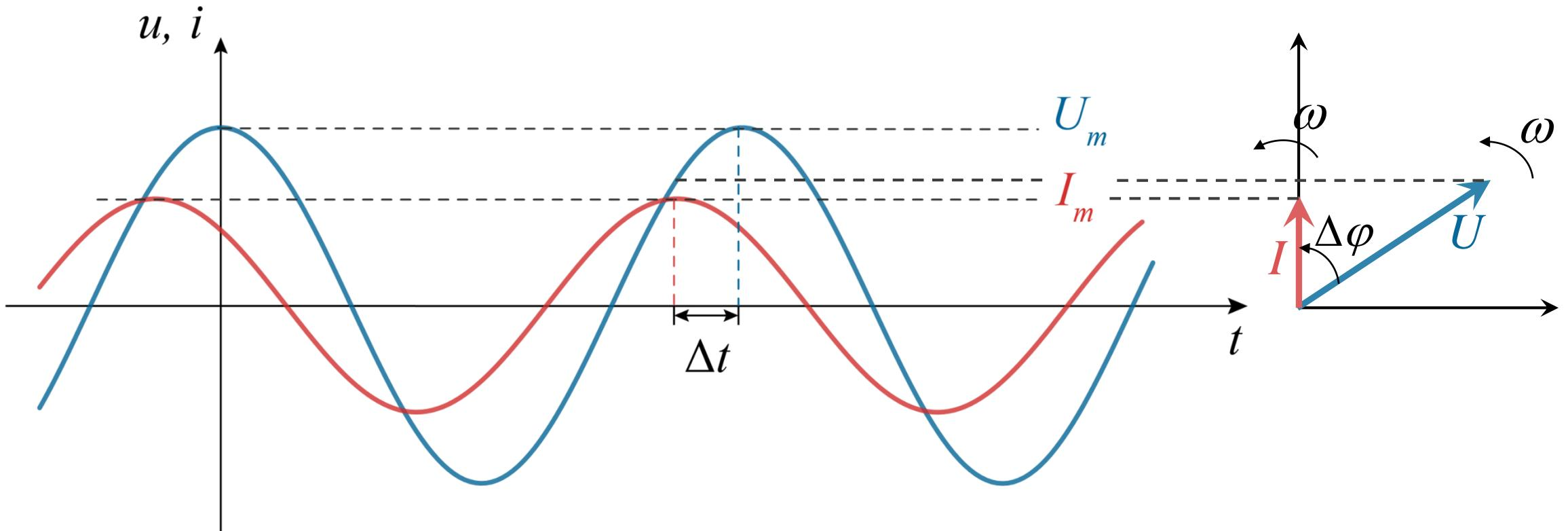
Graficul de mai sus pune în evidență defazajul dintre tensiunea la bornele circuitului și intensitatea curentului:  $\Delta\varphi = \omega \cdot \Delta t$  (tensiunea este defazată în urmă cu  $\Delta\varphi$  față de intensitate, circuitul fiind capacativ în acest exemplu).
