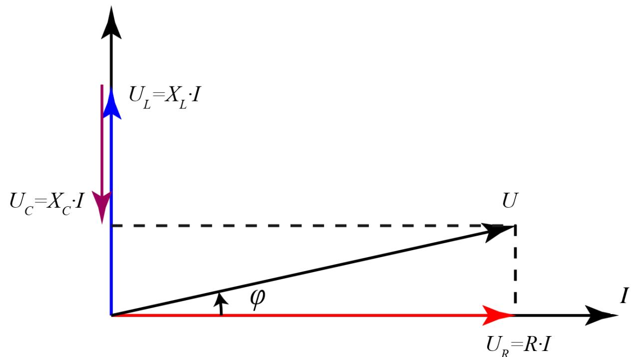
Suma vectorială a acestor trei fazori este egală cu tensiunea la bornele circuitului. Din diagramă se observă că tensiunea  $U$  este defazată față de intensitate cu un unghi care poate fi calculat în triunghiul dreptunghic astfel:
