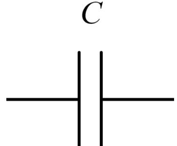
Elementele reactive de circuit (bobina și condensatorul) înmagazinează energie în câmpul magnetic (în cazul bobinei) sau în câmpul electric (în cazul condensatorului). Aceasta este periodic eliberată înapoi în circuit.
